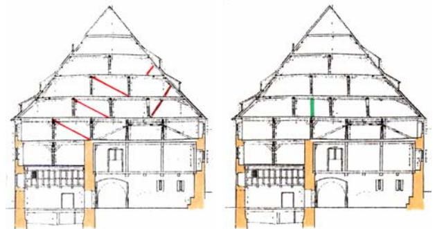
Querschnitt mit entfernten (rot) und hinzugefügten Traggliedern (grün)
