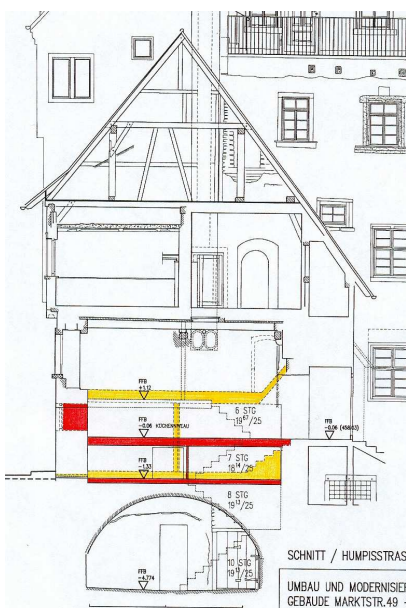
Querschnitt: Abbruch (gelb) Neubau (rot)
